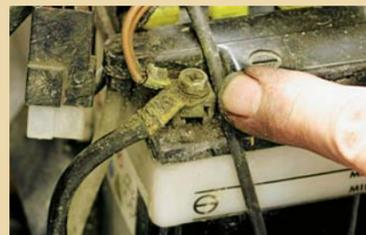
Wer solch vergammelte Anschlüsse spazieren fährt, darf sich nicht über Kontaktschwierigkeiten mokieren
