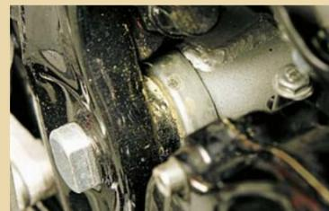
Und diese Sauerei sieht zum Beispiel so aus: massive, irreparable Säureschäden auf dem Schwingenlager
