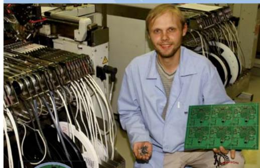
**3** Der SMT-Automat von Sascha (25) nimmt die Bauteile von einer Rolle und setzt sie auf die Leiterplatte. Das dauert eine Minute pro Platte
