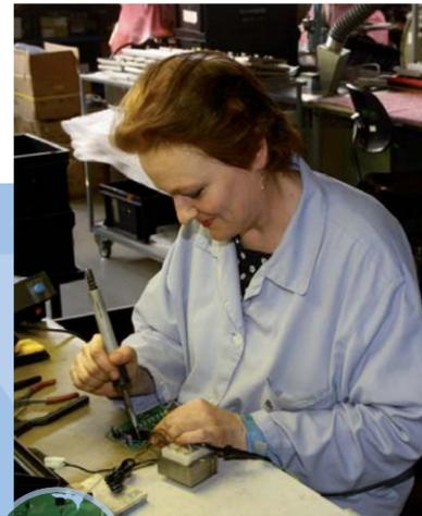
**5** Einige der 130 Teile (z. B. den Trafo) lötet Valeria (50) von Hand ein: zehn feinste Lötstellen in 1,5 Minuten
